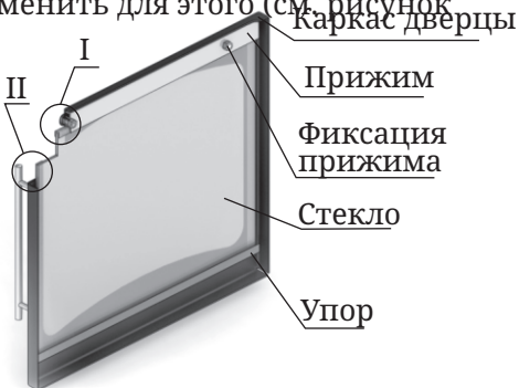
Рисунок 12. Ремонт светопрозрачного экрана дверцы модели «Витра»
