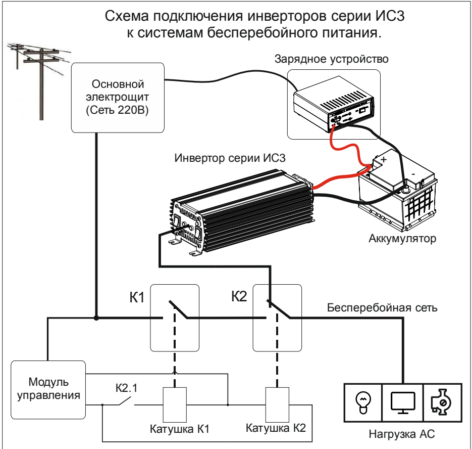
Рисунок 5 Схема подключения инверторов серии ИС3 к системам бесперебойного питания
