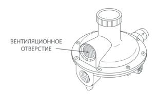
посторонних предметов. Если регулятор устанавливается в помещении или в каком-либо корпусе (коробе), необходимо установить сбросной трубопровод, выходящий за пределы замкнутого пространства. Наружный конец сбросного
